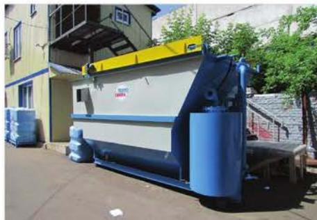
многоступенчатых установок. Оригинальная конструкция камеры позволяет сочетать в себе методы флотации и пенной сепарации, что обеспечивает высокое качество очистки сточных вод со значительными входными загрязнениями. В целях повышения эффективности удаления пены и предотвращения ее разрушения в отстойной зоне предусмотрена плавная регулировка скорости движения механизма удаления пены.
